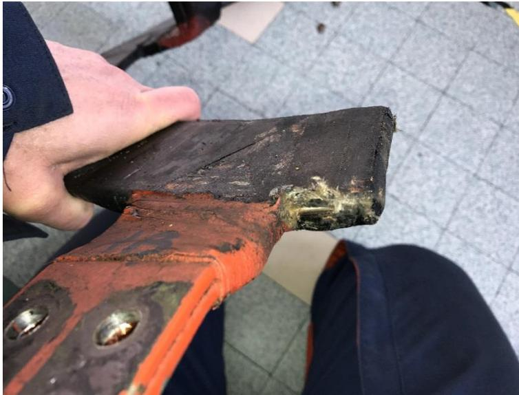
**Isolation connexion inter-polaire rompue
