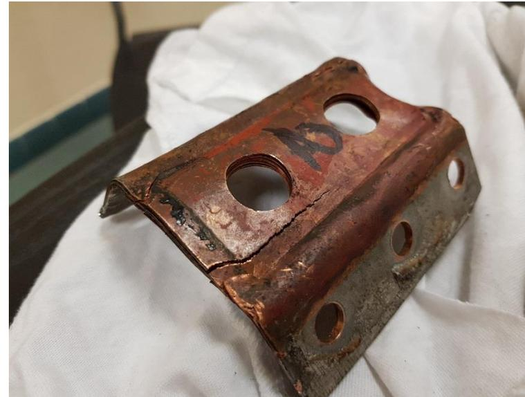
**Connexion inter-polaire fissurée
