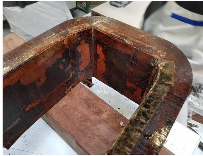
**Remplacement isolation de masse rotor HYDRO ALPES.
